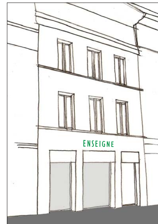
Les vitrines prennent place dans les ouvertures de maçonnerie, entre les éléments de structure.
