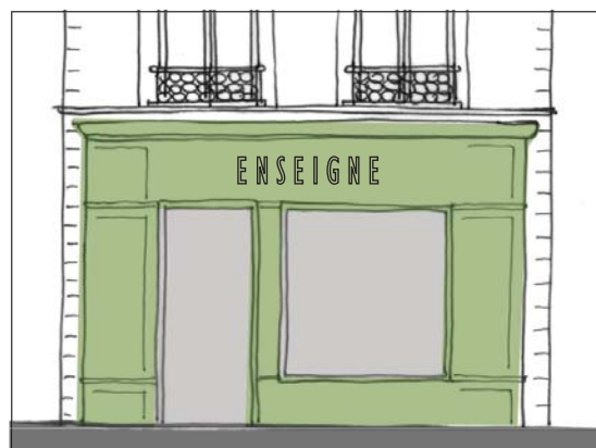
Devanture en applique, vue en élévation
